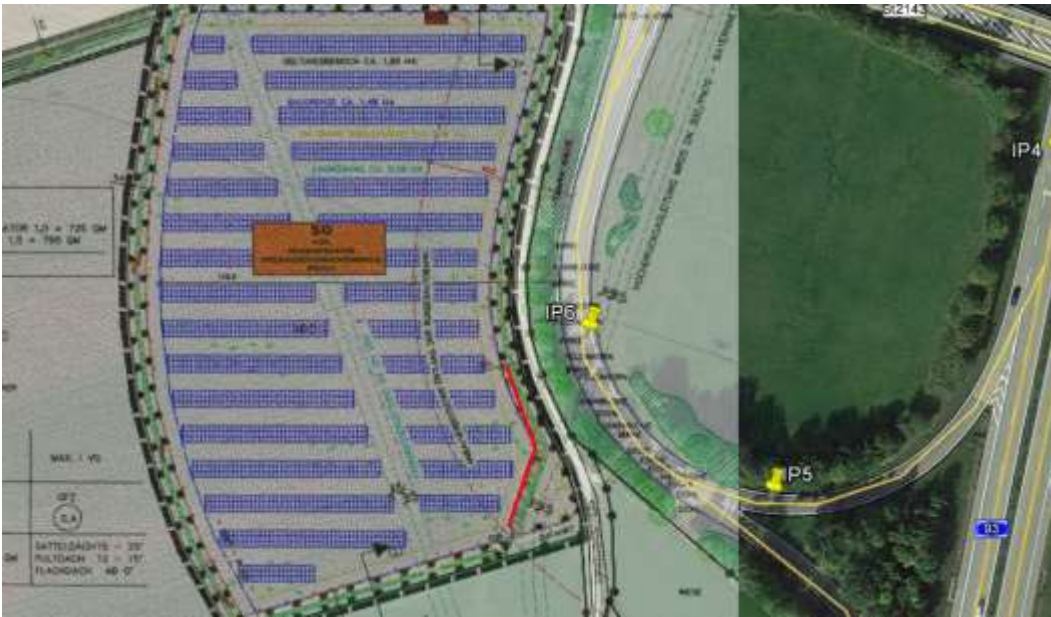
Abbildung 13 Abschirmung der Reflexionen
