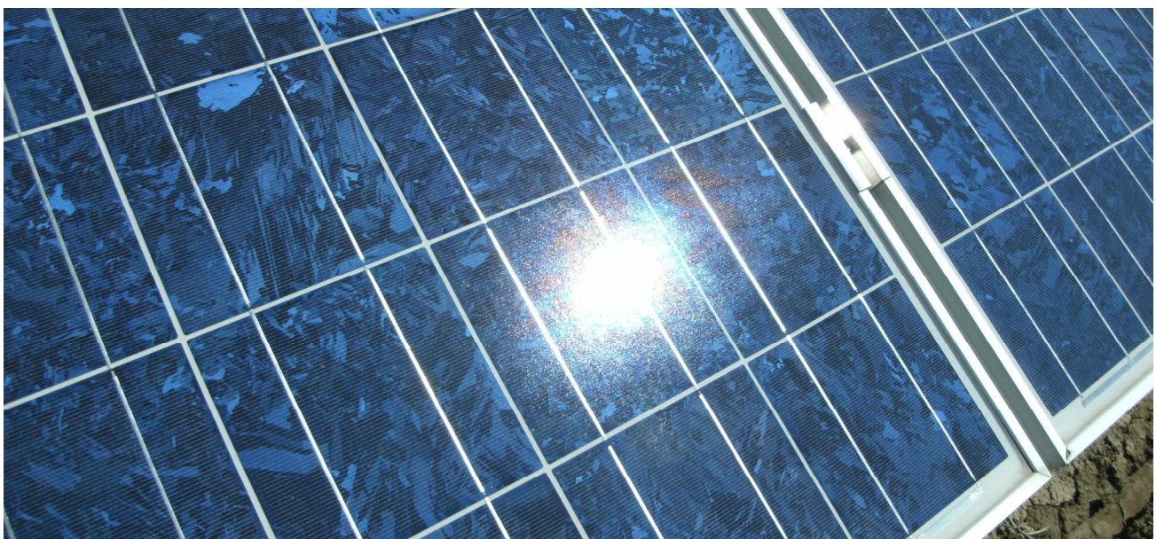
Bild S8: Diffuse Reflexion von direktem Sonnenlicht (Einstrahlung ca. 980 W/m 2 ) auf einem PV Modul (Quelle: SolPEG)
